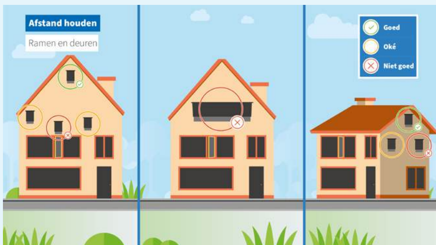
Figuur 3.4: Schematische weergave van hoe bij het aanbieden van nieuwe verblijfplaatsen rekening gehouden moet worden met aanwezige obstakels en ramen en deuren (bron: Erik Korsten, Zoogdierverseniging).
